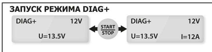
**Меры предосторожности :** Если на экране значение тока более 10А, это значит, что ваша АКБ разряжена. В этом случае, GYSFLASH начнет генерировать ток зарядки. Проверьте, что потребители автомобиля отключены. Дождитесь, когда ток будет ниже 10 А для начала диагностики.
