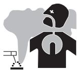
Выделяемые при сварке дым, газ и пыль опасны для здоровья. Вентиляция должна быть достаточной, и может потребоваться дополнительная подача воздуха.
